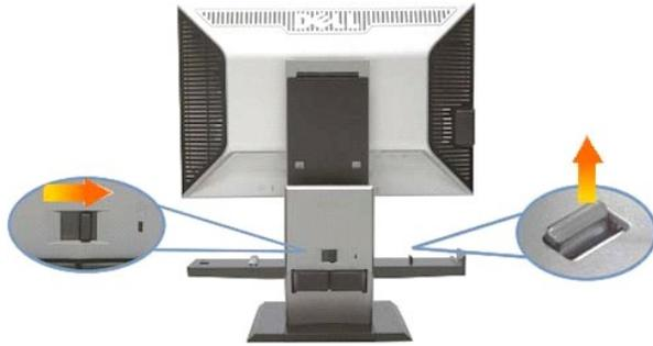
**3. Setzen Sie den Computer so in den Ständer ein, dass die Rückseite des Computers auf der Stufe ruht**
